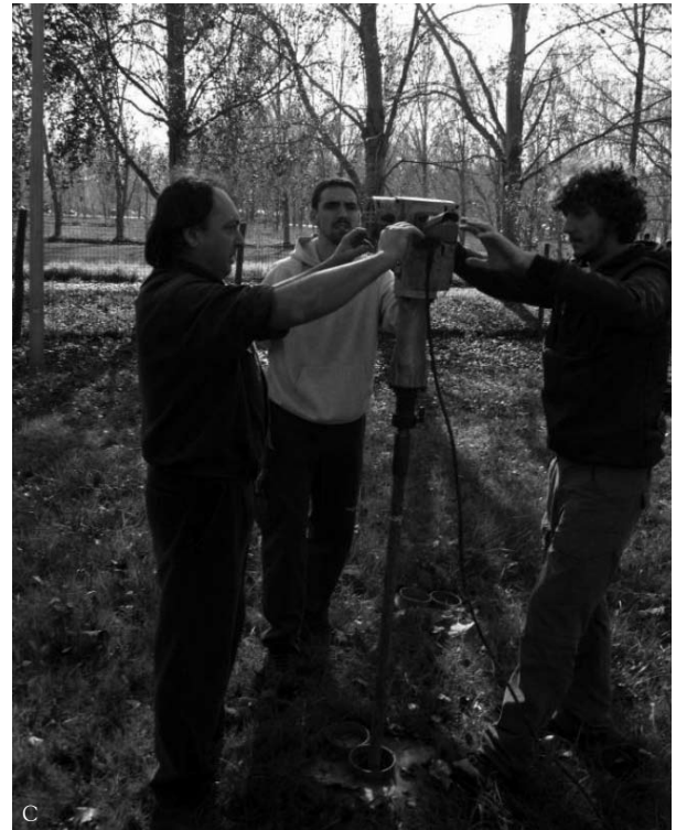
A. Extracció de la columna amb l'ajut de gat hidràulic. B. Detall de les bateries de finestres. C. Sonda pneumàtica, detall del martell.
