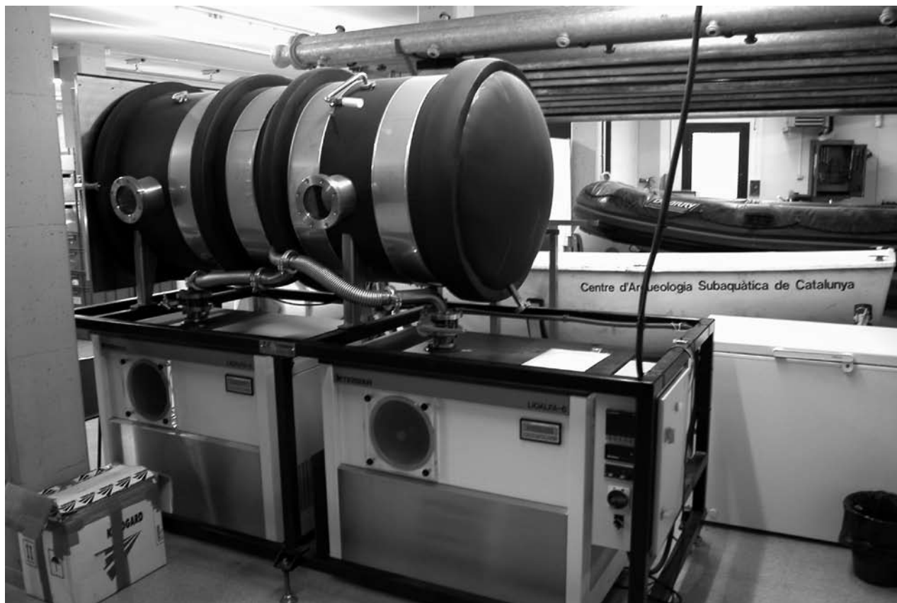
Liofilitzador del Centre d'Arqueologia Subaquàtica de Catalunya, on es restauren els materials orgànics recuperats a la Draga (foto CASC).
